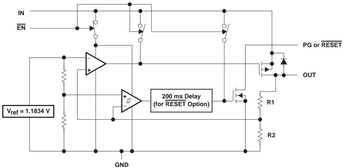
**TPS77701, TPS77715, TPS77718, TPS77725, TPS77733 with  $\overline{\text{RESET}}$  OUTPUT**
